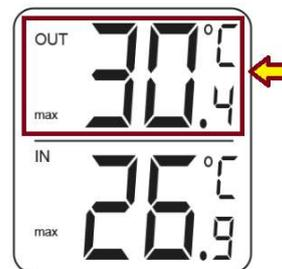
Hinweis: Drücken Sie die **"RESET-OUT"**, den Speicher von der minimalen und maximalen aufgezeichnet Temperatur für Hilfe zu löschen. Wenn Sie nach dem Zurücksetzen **"MIN/MAX-OUT"** drücken, entsprechen die minimalen und maximalen Aufzeichnungen der Außentemperatur der aktuellen Außentemperatur.
