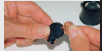
De behuizing openen, bijv. met een muntstukje van 1 cent
