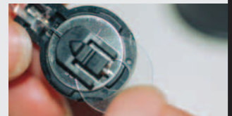
Kunststofschijs tussen schakelaar en batterijen
