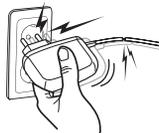
La douille desserrée peut générer de la chaleur, ce qui peut causer une fuite électrique car le cordon d'alimentation a fondu. (Peut causer un choc électrique ou s'enflammer)
