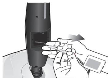
4. Entfernen Sie den alten Akku und setzen Sie einen neuen Akku ein.
