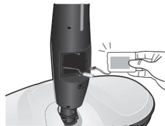
5. Verbinden Sie den Stecker wieder ordnungsgemäß mit dem Akkukabel.
