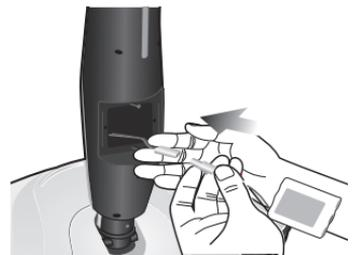
6. Setzen Sie die Akku-Abdeckung wieder ein und befestigen Sie die Schrauben.
