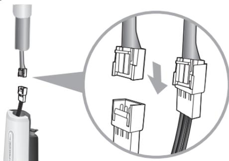
3. Verbinden Sie den Griff mit dem Hauptteil (der bauchige Teil am unteren Ende der Griffstange (Federstift) wird mit dem Bajonettverschluss am oberen Ende des Hauptteils verbunden).
