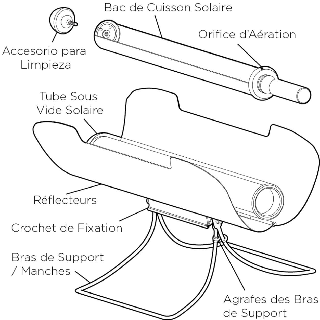
**Poids:** 3.18kg / **Volume Four:** 1.4kg de nourriture / **Température Maximale:** 371°C / **Température de Fonctionnement :** 93°-288°C / **Durée de Cuisson :** à peine 10 minutes
