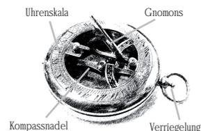
Klappen Sie den GNOMONS (dies ist der Zeiger der Sonnenuhr) nach oben, so dass dieser senkrecht steht. Danach drehen Sie den Kompass solange bis die rote Spitze der Kompassnadel auf N zeigt. Nun können Sie, vorausgesetzt die Sonne scheint, die Uhrzeit auf dem Deckel ablesen. Wenn Sie die Verriegelung an der Ringöse betätigen springt der Deckel auf und Sie können den Kompass Ideal zur Kursbestimmung verwenden.
