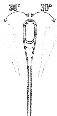
La tête de la lampe peut être ajustée latéralement (droite / gauche) dans un angle de 60 degrés (30 degré à la gauche et 30 degrés à la droite).
