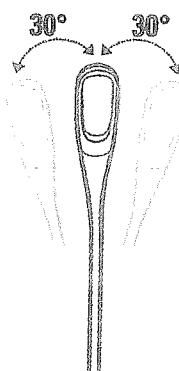
Der Lampenkopf kann seitwärts angepasst werden (rechts/links) innerhalb eines 60 Grad-Winkel (30 Grad nach links und 30 Grad nach rechts).
