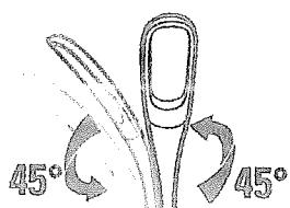
De hals van de lamp kan horizontaal draaien (links/rechts) binnen een hoek van 90 graden (45 graden naar links en 45 graden naar rechts).
