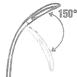
Der Lampenhals kann vertikal eingestellt werden (hoch/runter) innerhalb eines 150 Grad-Winkel.
