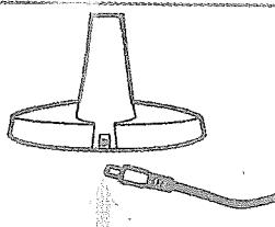
Branchez l'adaptateur dans le trou à l'arrière de la base de la lampe et insérez la fiche dans la prise.
