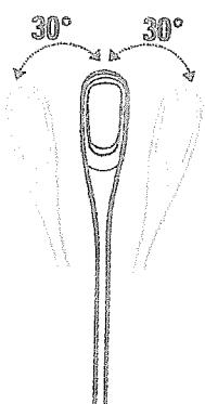
Het hoofd van de lamp kan zijwaarts worden aangepast (rechts/links) binnen een hoek van 60 graden (30 graden naar links en 30 graden naar rechts).
