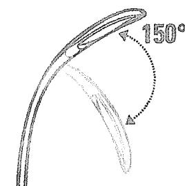
Le col de la lampe peut être ajusté verticalement (haut-bas) dans un angle de 150 degrés.
