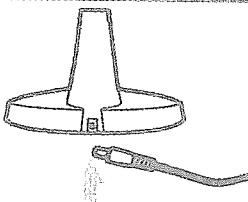
Schließen Sie den Adapter in die hintere Öffnung des Lampensockels und stecken Sie den Stecker in eine Steckdose.
