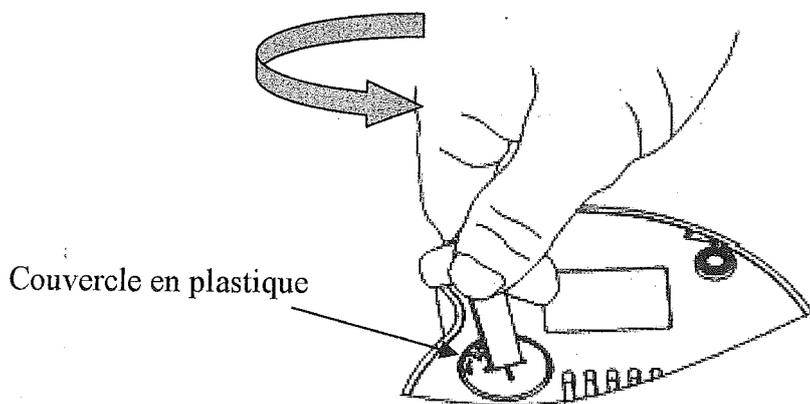
2. Utiliser un objet pointu pour presser la partie indiquée sur le dessin afin de retirer la pile.
