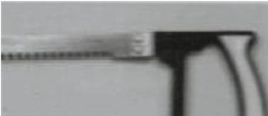
Sie können das flache Sägeblatt nach oben oder unten gerichtet einsetzen, je nach Art der Arbeit, die Sie verrichten möchten.
