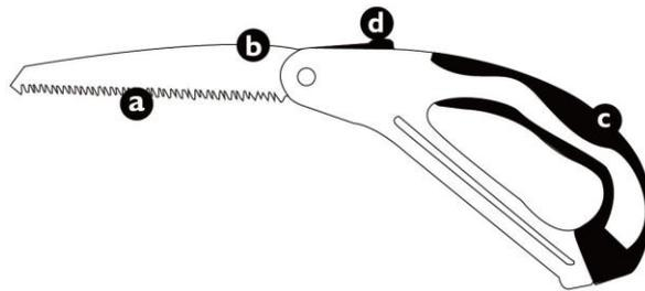
**a** Extrem scharfe Dreieckszähne schneiden fünfmal schneller als ein herkömmliches Sägeblatt.
