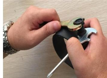
2. Drehen Sie diese mit Hilfe eines Schraubenschlüssels durch die Öffnung, wobei Sie den Schlüssel an den fest sitzenden Muttern direkt an den Pedalen ansetzen.
