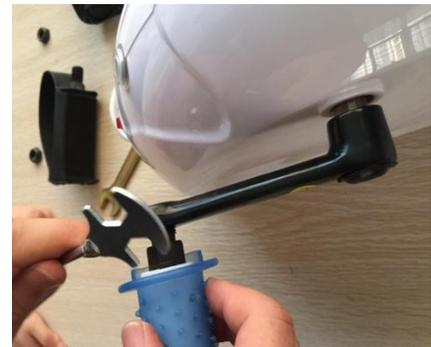
4. Drehen Sie die Gewindestangen in die rechte als auch linke Pedalhalterung mit Hilfe eines Schraubenschlüssels bis das Gewinde vollständig eingeschraubt ist.
