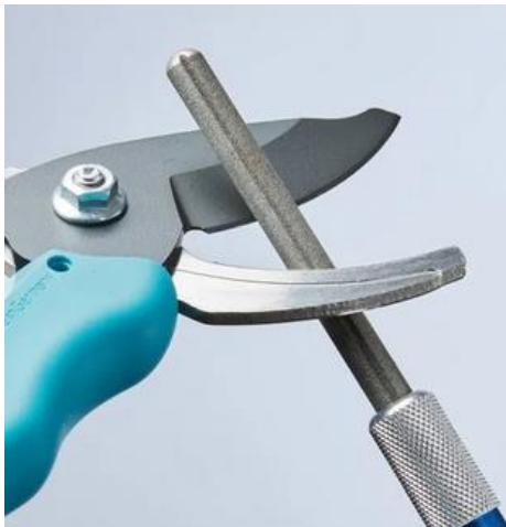
**Garten- und Astscheren:** Positionieren Sie das Werkzeug, wie im Bild dargestellt. Entfernen Sie feine Schleifreste und Überstände, indem Sie die flache Seite des Schärfers ein- bis zweimal verwenden.
