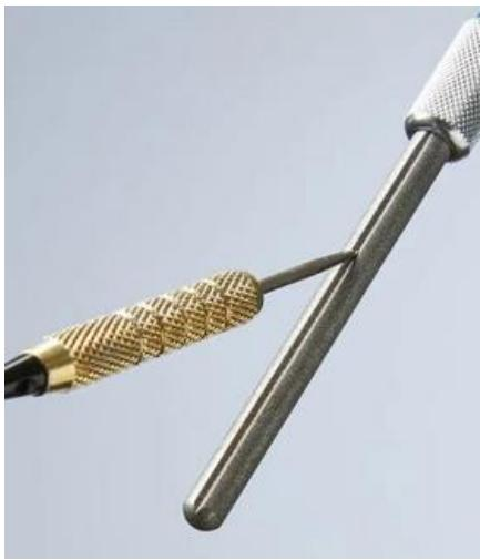
**Ahlen und Schreiber:** Halten Sie das Schleifwerkzeug wie auf dem Bild angegeben. Während Sie den Schleifer rotieren, folgen Sie der vorgegebenen Rille, damit der Schliff zentriert bleibt. Auch für Dartspfeile geeignet.
