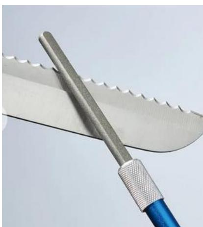
**Gezackte Klingen (inkl. Multifunktionswerkzeuge):** Halten wie im Bild ersichtlich. Folgen Sie dem Winkel der Grundkante und schärfen Sie jede einzelne Zacke mit Auf- und Ab-Bewegungen. Sofern scharf, überschüssige Schleifreste und Überstände entfernen.
